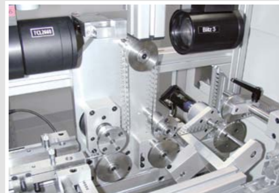
Streifenumlenkung zur Freistellung der zu prüfenden Merkmale
