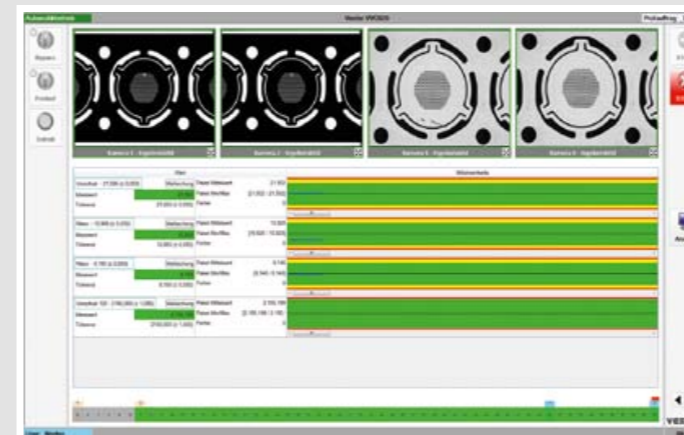
Prozessdisplay im Prüfbetrieb: Prüfbilder und Messwertanzeige
