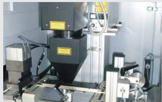
Oben: Innenansicht LASERmark VLM 600 mit : Strahl- und Ablenkeinheit mit Absaughaube, Streifenführung und Streifenvorschub, Triggerlichtschranke, Trenn- bzw. Markierwerkzeug mit Lichtschranke, Türschutzschalter
