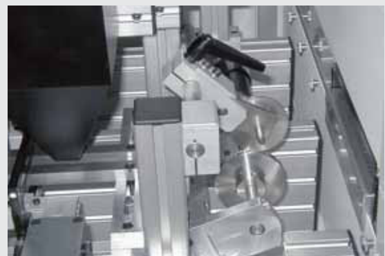
Unten: Servo-Bremsmotor mit austauschbarem Stachelrad, für unterschiedliche Teilungen
